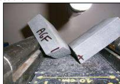
*Particolari del provino durante la prova di flessione*
