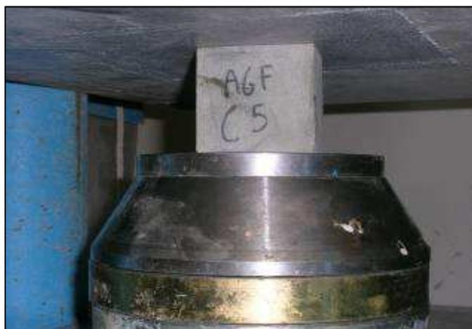
*Allestimento della prova a compressione*
