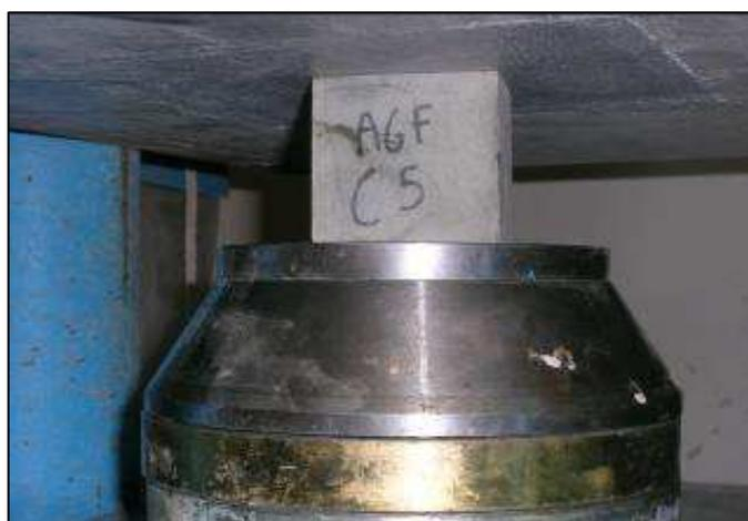
*Allestimento della prova a compressione*
