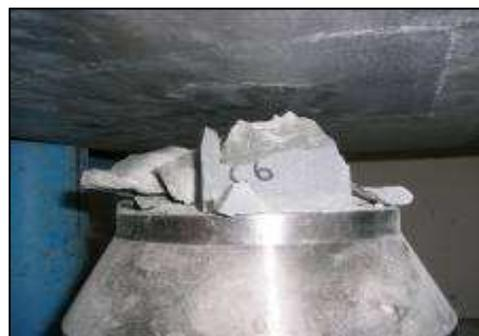
*Particolari del provino dopo la prova di compressione*
