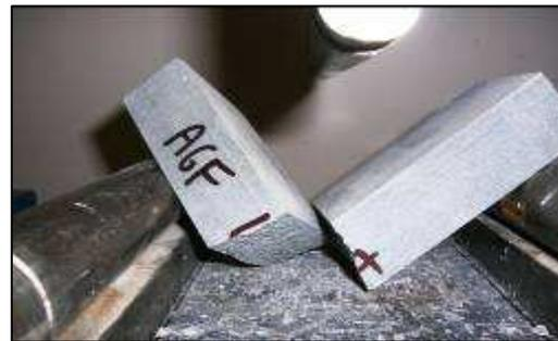
*Particolari del provino durante la prova di flessione*
